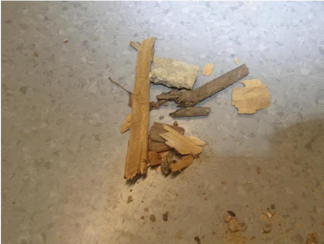
Kuva 13. Rakenneavaus, RAKL3, vanhan musiikkiluokan alapohjarakenteeseen. Alapohjan maatytyteessä havaittiin jonkin verran vanhaa puumateriaalia.
